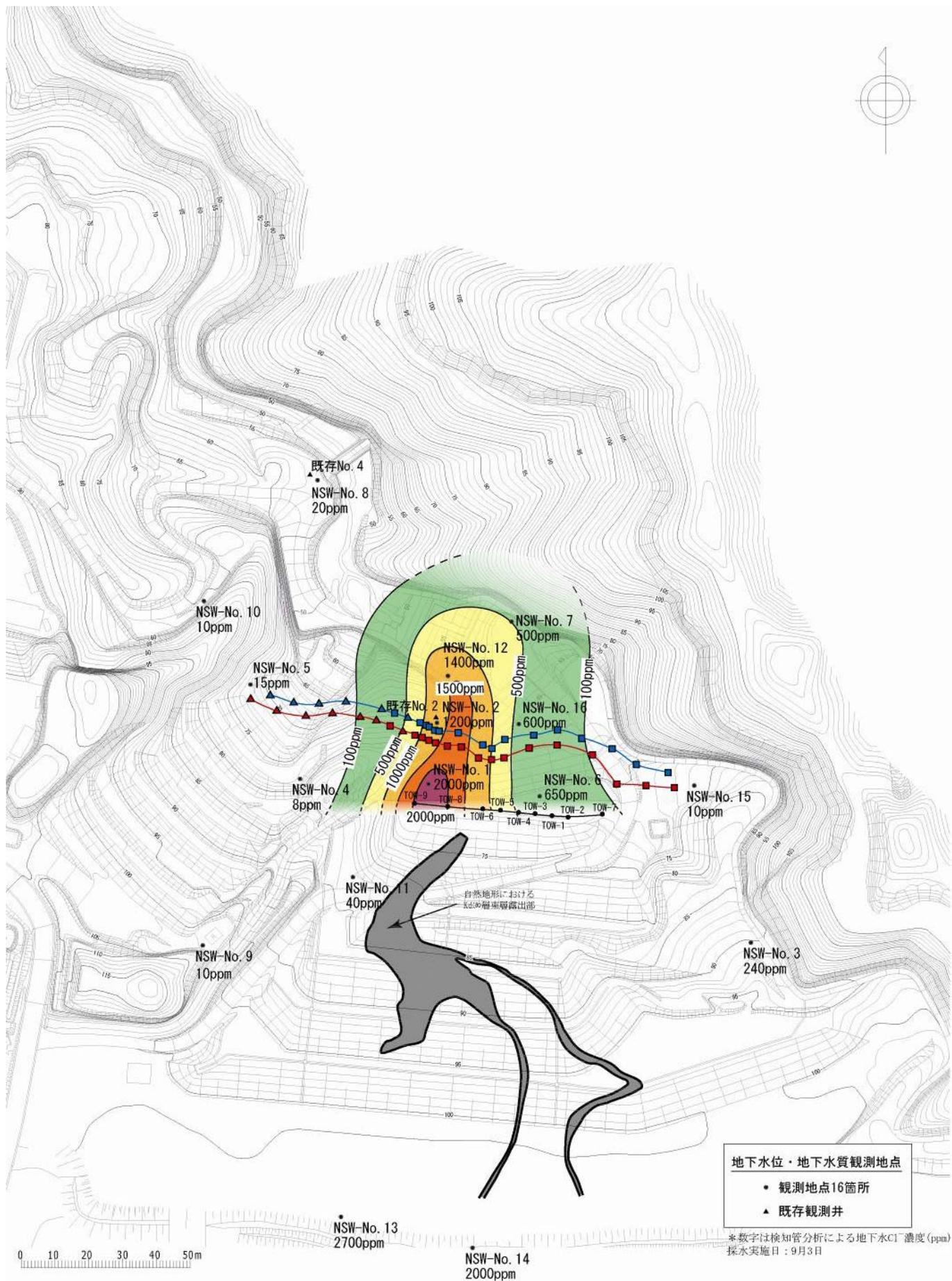
図一34 モニタリング・システムからの Kd38 透水層の塩素イオン (Cl<sup>-</sup>) 濃度分布
