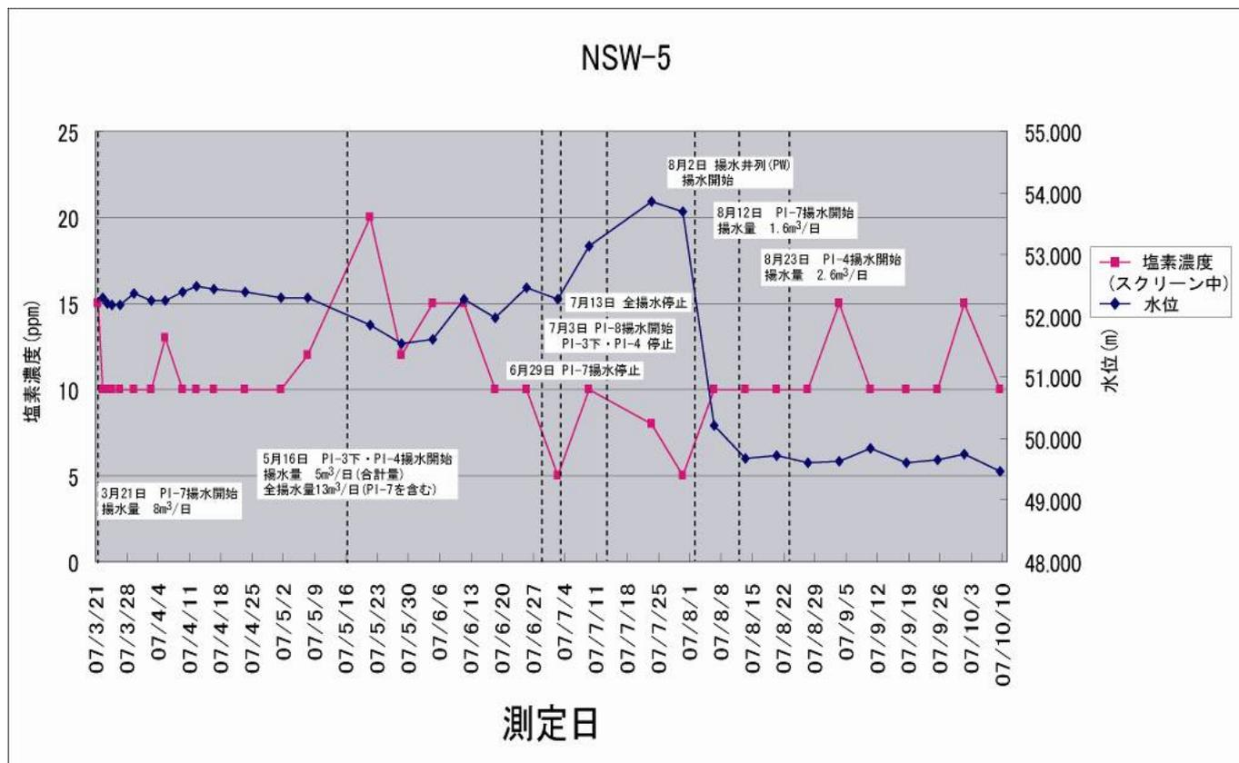
図一9 揚水・停止試験に伴うモニタリング・システム井(NSW-5)の水位変動・塩素濃度変動
