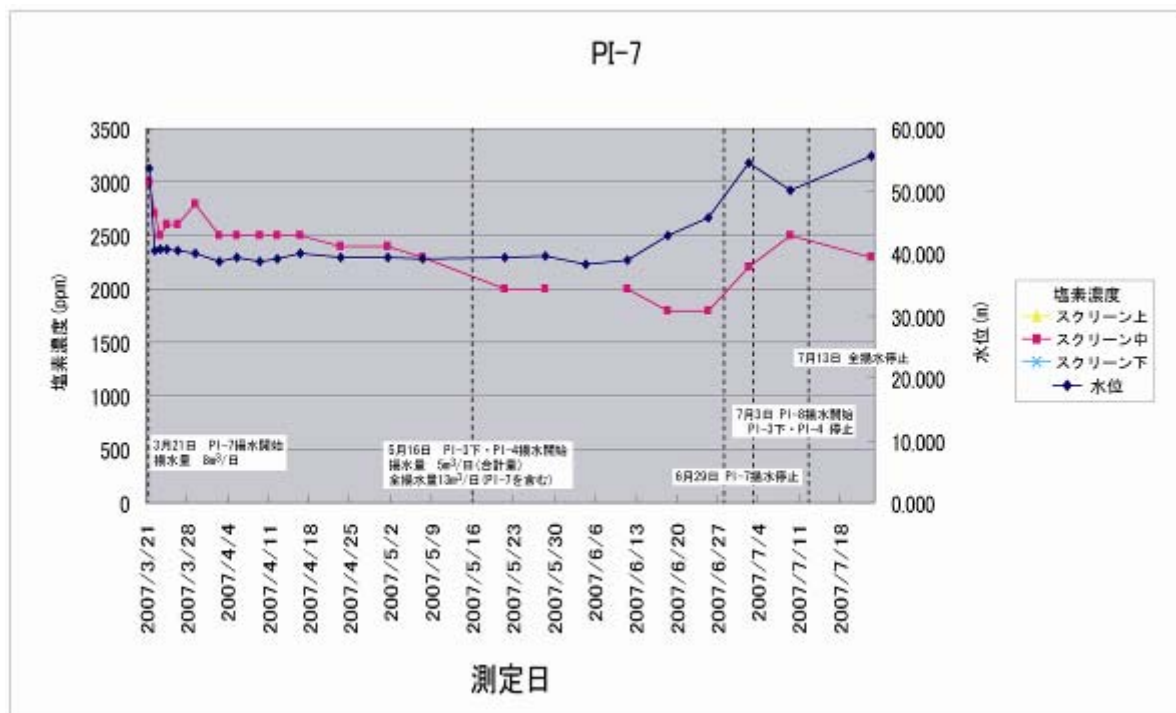
図—9 実証試験地における観測井(PI-7)での揚水・停止試験にともなう 水位変動・塩素濃度変動
